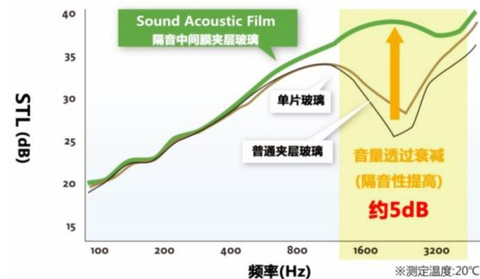
音量透过衰减越大，隔音性能越高
